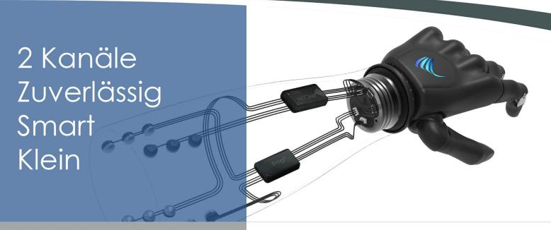
Die emg2 ist die derzeit kleinste digitale Oberflächenelektrode zur Messung von Muskelaktionspotentialen für die Steuerung von myoelektrischen Prothesen, mit zwei Kanälen.
